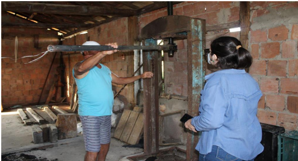
Imagem 33 – Equipamento da bolandeira, prensa à braço. Fonte: Arquivo pessoal da autora, 10/09/22
