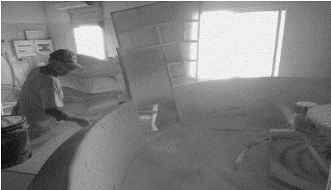
Imagem 18 - Forno utilizado na torração. Fonte: Arquivo pessoal da autora,2020.
