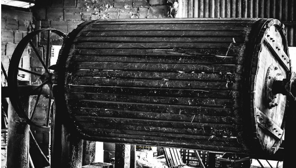
Imagem 15 – Lavador: equipamento utilizado na etapa de lavagem da mandioca. Fonte: Arquivo pessoal da autora, 2020.
